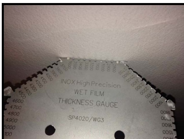
Figure 6 : Contrôle de l'épaisseur de l'enduit Alltek Spray Etanch'R
